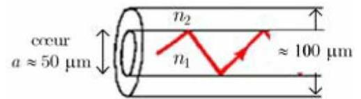
Fig. 1 - Guide d'ondes diélectrique
