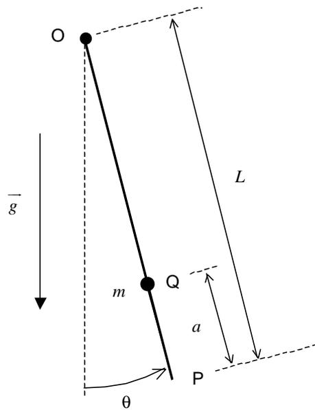
16. Lorsque  $\theta = \theta_1$ , la masse  $m$  revient instantanément en P (sa vitesse angulaire est alors nulle et ne change par conséquent pas de valeur). Le pendule revient vers la position d'équilibre où la masse  $m$  passe à nouveau de P à Q. Le pendule continue son mouvement et atteint l'élongation  $\theta_2$ . Calculer  $\theta_2$ .
