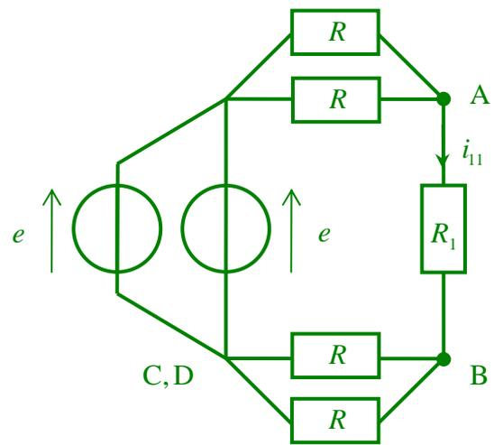
On en déduit, sur le dernier schéma :  $i_{11} = \frac{e}{R+R_1}$  et  $i_{21} = 0$
