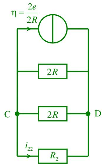
La branche AB, située dans le plan d'antisymétrie, n'est parcourue par aucun courant. On peut donc supprimer la résistance  $R_1$  sans modifier la situation électrique du réseau. Les deux mailles supérieures n'en font plus qu'une et l'on peut y associer deux générateurs linéaires en série.
