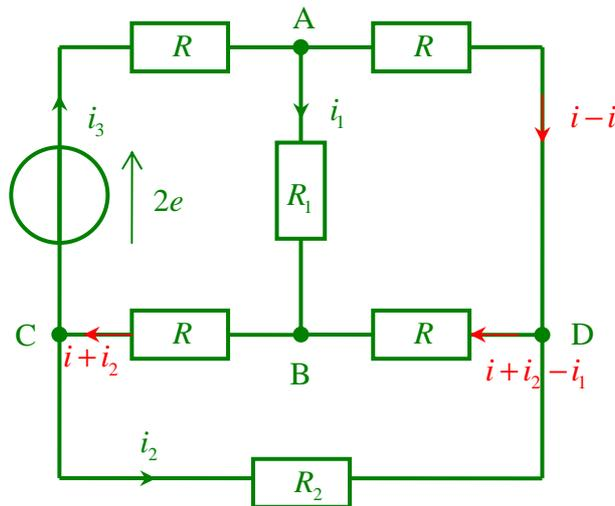
Les courants dans les branches AD, DB et BC s'expriment en fonction de  $i_1$ ,  $i_2$  et  $i_3$  en appliquant la loi des nœuds. Les trois équations de mailles s'écrivent alors :
