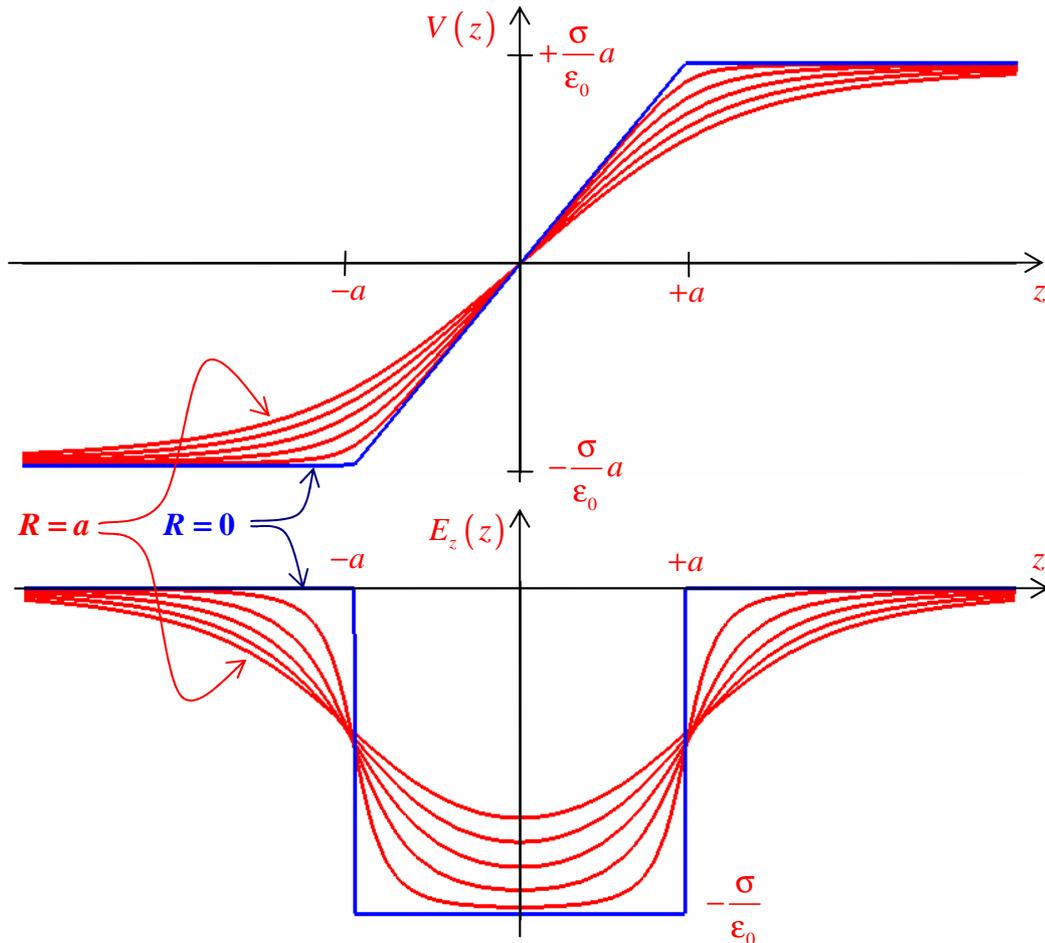
Nous observons que pour  $R = 0$ , on retrouve le champ et le potentiel créés par deux plaques parallèles de charges surfaciques opposées.
