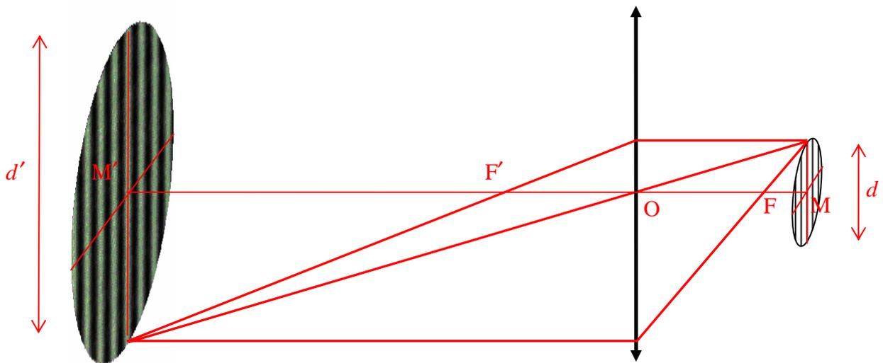
Nous en déduisons la distance  $\overline{OM'}$  de la lentille à l'écran ainsi que la distance  $\overline{MO}$  du miroir à la lentille :
